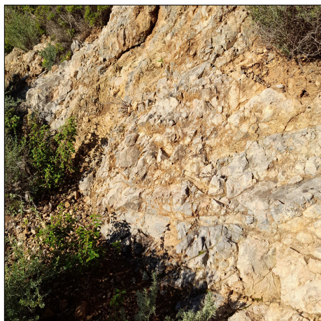
Foto 6 e 7 - Esempi di discontinuità dell'ammasso roccioso
